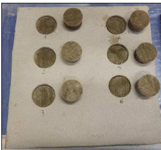
Foto 4. Stesso pannello dopo test di pull off.
