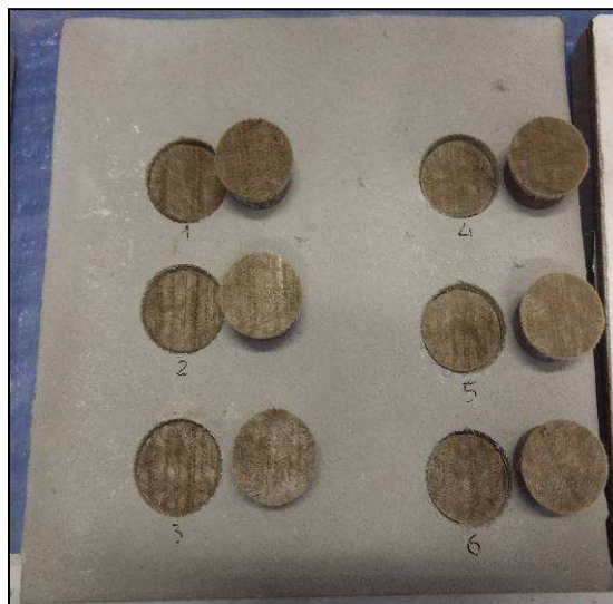
Foto 2. Stesso pannello dopo test di pull off.
