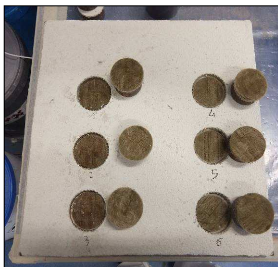
Foto 6. Stesso pannello dopo test di pull off.
