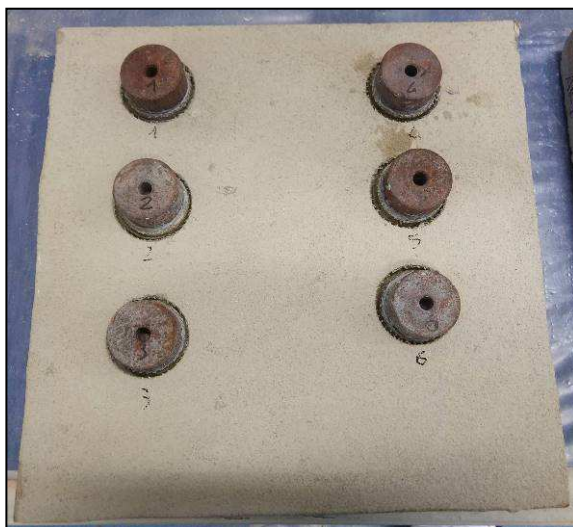
Foto 3. Pannello NOBILIUM® THERMALPANEL rasato ed incollato con Mapetherm AR1 GG.
