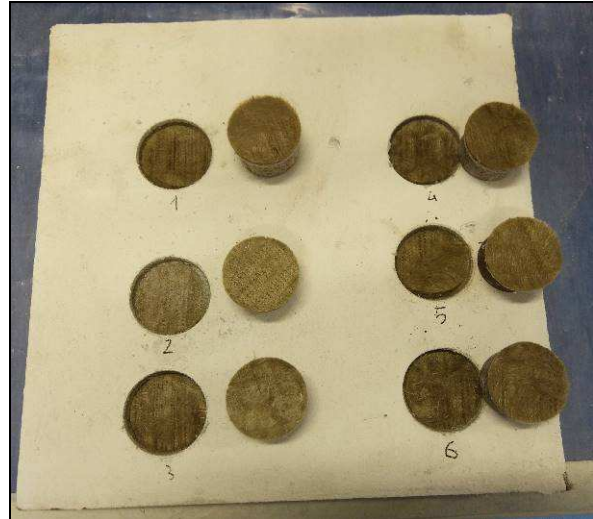
Foto 8. Stesso pannello dopo test di pull off.
