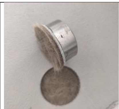
Immagine 3: Pannello dopo il test. Rottura Pannello
